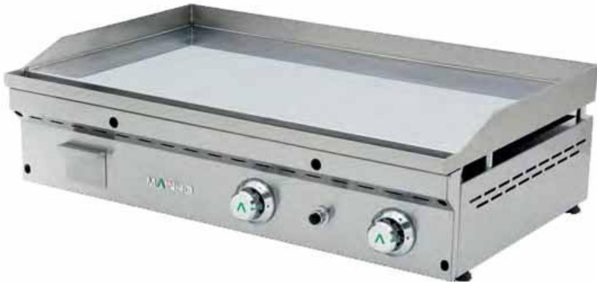
**Plancha a gas de sobremesa Mainho FC-90** de cromo duro de 20mm de espesor y cajon recolector delantero. encendido por tren de chispas en bateria - válvulas termostáticas con llama piloto. Ideal para hosteleria
