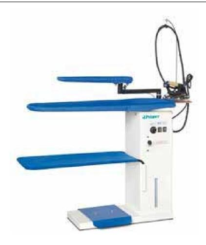
Mesa de repaso FDA de Primer, Mesa aspirante con caldera, con plato universal y calentada eléctricamente. Versión con caldera eléctrica incorporada, bomba de alimentación de agua, depósito de agua y plancha de vapor. Aspirador monofásico incorporado accionado mediante pedal. Temperatura del plato regulable por termostato. Pedales a ambos lados de la máquina.
