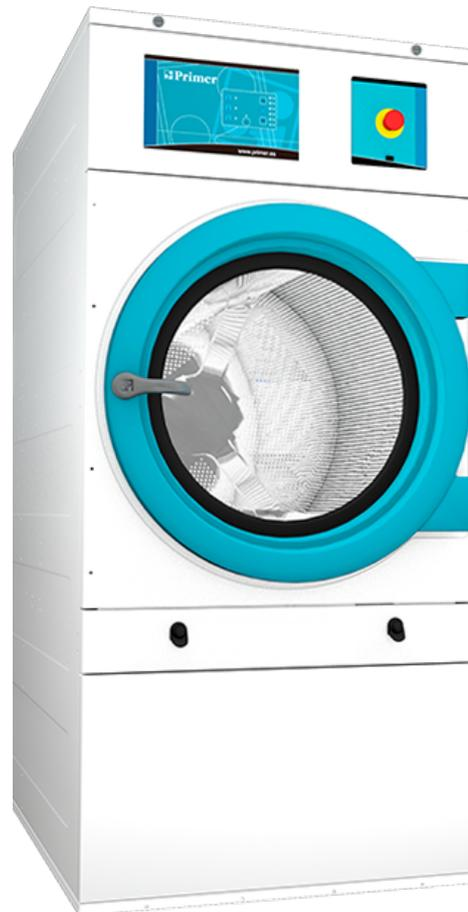
**Secadora industrial línea Básic Primer DL-22P GAS.** Control analógico de tiempo y temperatura de secado. Inversión de giro de serie, para evitar posibles enrollamientos en la ropa y así reducir el tiempo de secado (Spin Stop). Modelos 11/17/23: la transmisión va directamente al eje mediante motor reductor.
