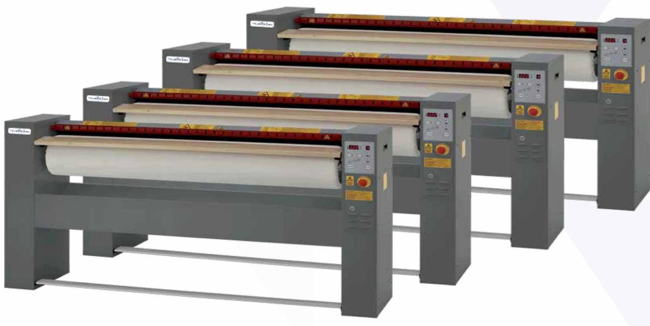
**Rodillo PG 161 Tecnitramo** con entrada y salida frontal, con pedal de accionamiento. Termostato de seguridad para evitar sobrecalentamientos. Protección automática de las manos y paro de emergencia para mayor seguridad. Con funda NOMEX®
