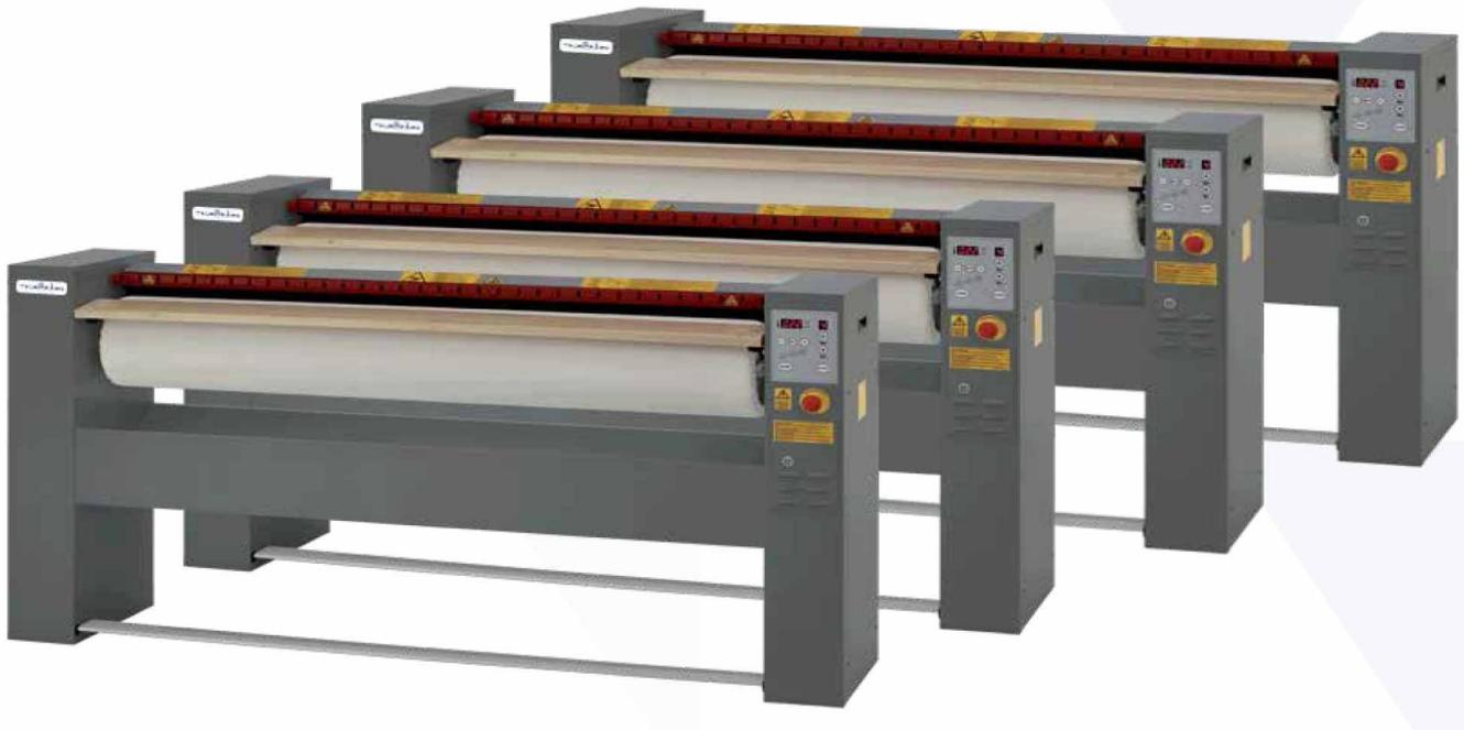
**Rodillo PG 200 Tecnitramo** con entrada y salida frontal, con pedal de accionamiento. Termostato de seguridad para evitar sobrecalentamientos. Protección automática de las manos y paro de emergencia para mayor seguridad. Con funda NOMEX®
