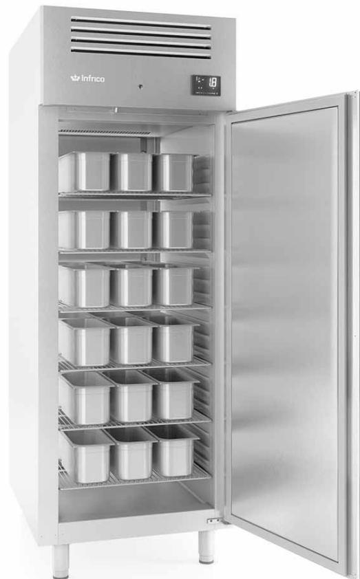
Congelador vertical para **heladería INFRICO AGB 901 BT** con 785 L de capacidad (54 cubetas de 5L) y rango de temperaturas de -22-25°C, un armario para pastelería con parillas de 600x400mm con sistema de refrigeración compacto monoblock, desescarche por gas caliente, sistema de válvula de expansión.
