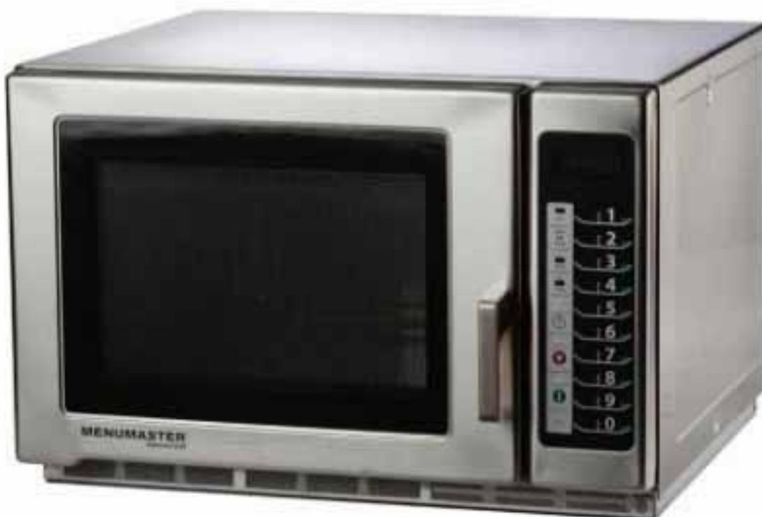
**Microondas profesional Menumaster RFS 518 TS** un microondas con acabado exterior y interior en acero inox. abado exterior e interior en acero inoxidable. Mandos electrónicos. Máximo tiempo de cocción: 60 minutos. Capacidad interior: 34 litros. Potencia de cocción: 1.800 W. El temporizador se reinicia automáticamente a cero si la puerta se abre durante el calentamiento. 5 niveles de potencia.
