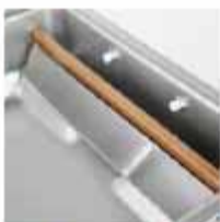
INYECCIÓN DE GAS Instalación para inyección de gas inerte en bolsa.
