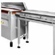
CINTA LATERAL Cinta lateral sincronizada para entrada de productos.
