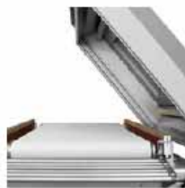
CINTA DESCARGA Cinta interior expulsora de producto.
