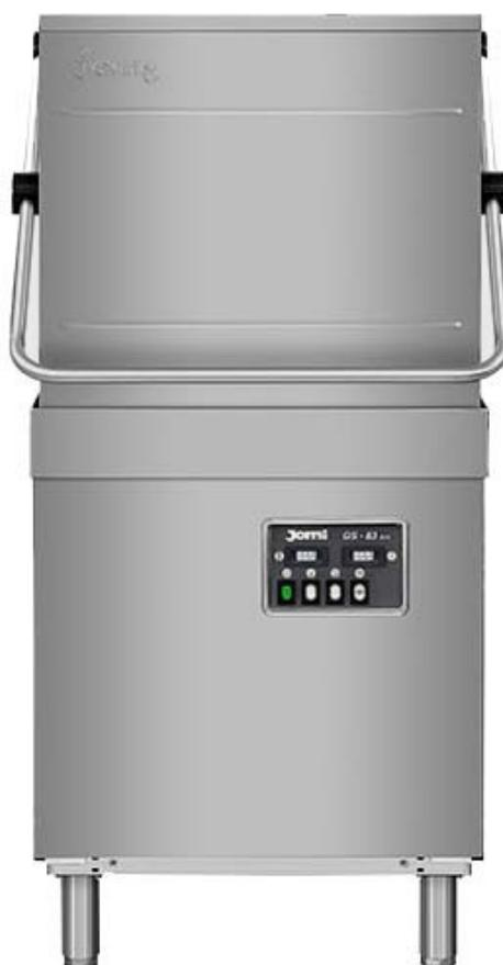
**JEMI GS-83 M es un lavavajillas profesional trifásico DE CÚPULA con precio muy competitivo** con cesta de 50X50cms, cúpula manual de fácil apertura y cierre con accionamiento de ciclo automático, con la cuba embutida de una sola pieza y sin soldaduras, brazos de lavado fijo de extracción directa para una fácil limpieza, triple filtro, termómetros analógicos, fácil limpieza y USO
