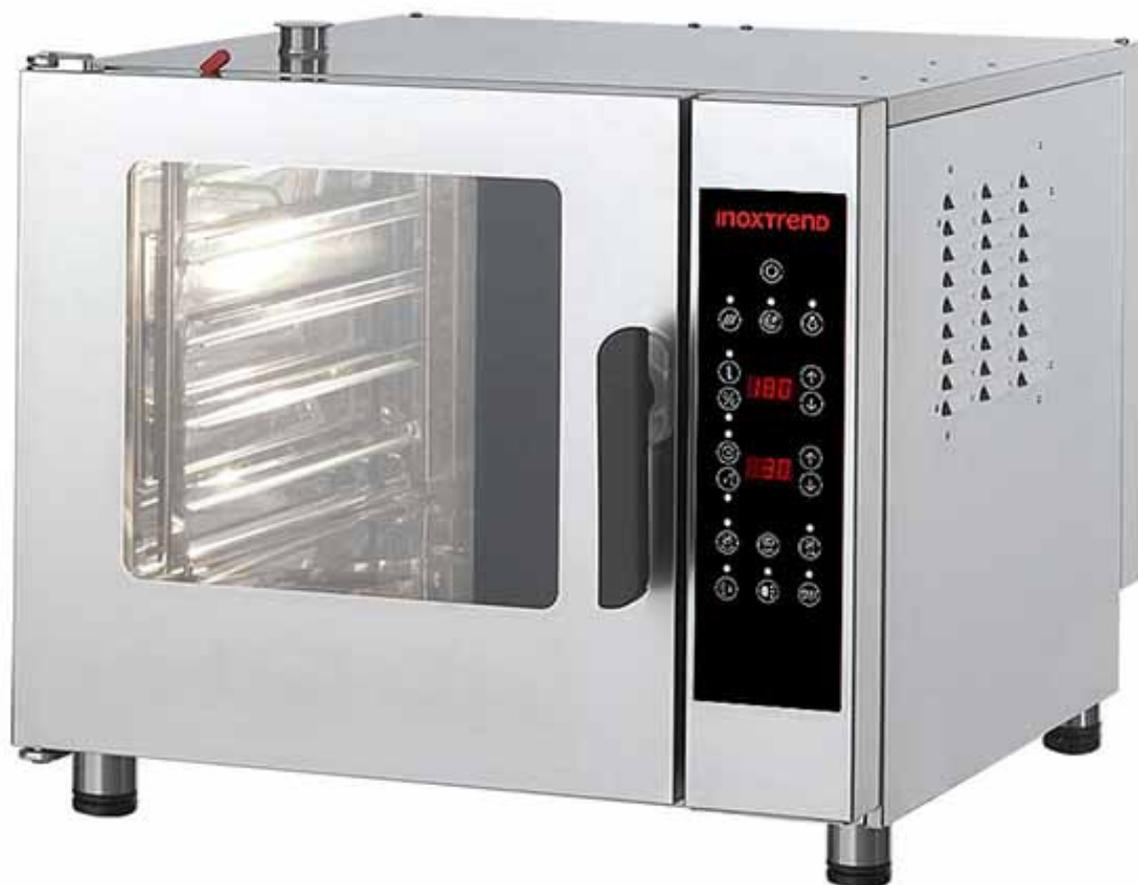
Horno profesional **Inoxtrend RDE-105E** de la serie Simple con capacidad para 5 bandejas GN 1/1, panel digital, temporizador, puerta con doble cristal y luz interior. Cuenta con válvula de evacuación de vahos y ciclo de enfriamiento rápido. Se convertirá en nuestro mejor aliado en la cocina gracias al acabado perfecto en cualquiera de sus modos de cocción (convección, vapor y mixto convección+vapor)
