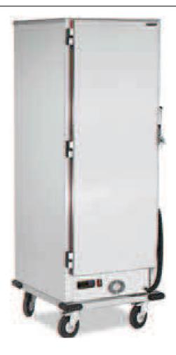
Carro caliente **ACR-1 de Distform**, especialmente diseñado para facilitar el transporte y servicio de comidas previamente preparadas. Cuenta con una capacidad para 17 GN 2/1 o 34 GN 1/1 y está fabricado en acero inoxidable AISI 304 18/10. Cuenta además con panel de mandos y doble pared de aislamiento en lana de roca para reducir la pérdida de calor y el consumo energético.
